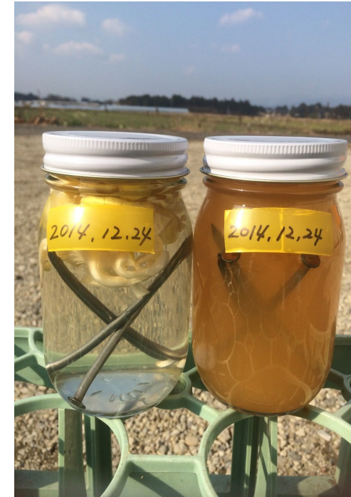
鉄くぎをビンに入れた実験 左:鉄くぎ+たもぎ茸 右:鉄くぎのみ
